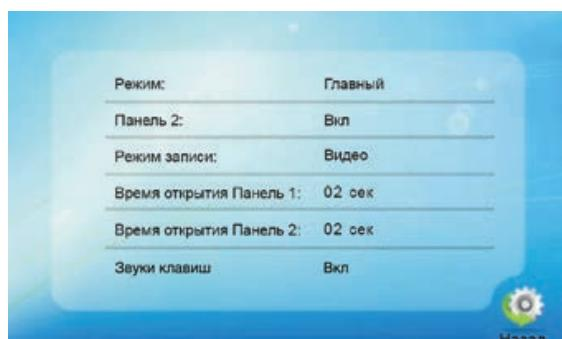
[Режим]: Выбор опции “Главный” или “Дополнительный”. “Главный” означает, что монитор домофона присоединен к вызывным панелям или камерам слежения. “Дополнительный” означает, что монитор присоединен к главному или дополнительному монитору.
