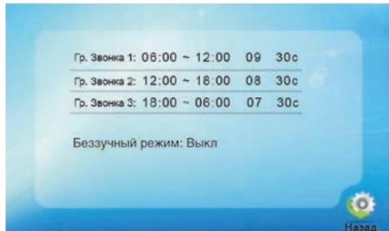
[Беззвучный режим]: Параметры «Вкл» или «Выкл». Включает / отключает все звуковые оповещения.
