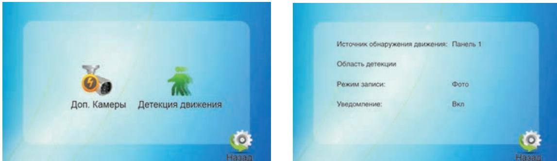
Программный детектор движения позволяет обнаруживать движение объектов без использования внешних датчиков, путем регистрации изменений, происходящих в области обзора используемой видеокамеры. Для реализации данной функции, питание камеры, используемой для детекции движения, должно быть постоянно включено. Это нужно для того, чтобы домофон имел доступ к изображению, поступающему с камеры и мог зарегистрировать его изменение
