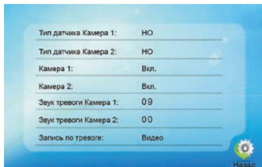
**[Тип датчика Камера 1 или Тип датчика Камера 2]:** Канал каждой камеры имеет определенный статус входов-выходов (смотрите пояснения ниже), то есть при срабатывании сигнала тревоги соответствующий канал активируется и начинает тревожную запись видеопотока или делает фотоснимок.
