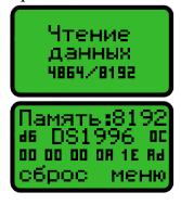
При включенной опции «Автоматическое чтение памяти», память считается автоматически после считывания кода, при этом на экране отражается прогресс операции «Чтение данных...». Для считывания памяти вручную в меню записи выберите «Память», затем «Считать».
