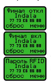
Для включения функции финализации (форматы Dallas, EM-Marine, HID, Indala) или пароля (формат EM-Marine, HID, Indala), при записи ключей нажмите кнопки «Вверх» или «Вниз». После считывания ключа функции финализации и пароля отключены.
