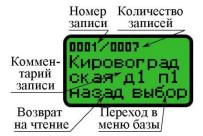
На верхней строке отображается номер текущей записи и общее количество записей в базе. Нажатие кнопок «Вверх» и «Вниз» позволяют пролистывать записи. Удержание указанных кнопок позволяет пролистывать записи быстрее.
