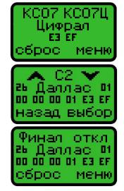
Для ключей Cyfral есть четыре варианта перекодировок, для Metakom два варианта. Выбор варианта перекодировки в основном определяется опытным путем.
