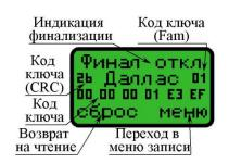
После считывания оригинального ключа, приложите ключ-заготовку к считывателю. По окончании записи дубликатор издаст звуковой сигнал и на экране отобразит результат записи: тип используемой заготовки. Во время записи держите ключ плотно, не шевелите заготовку. Для записи нескольких заготовок достаточно поочередно прикладывать их к контактору.
