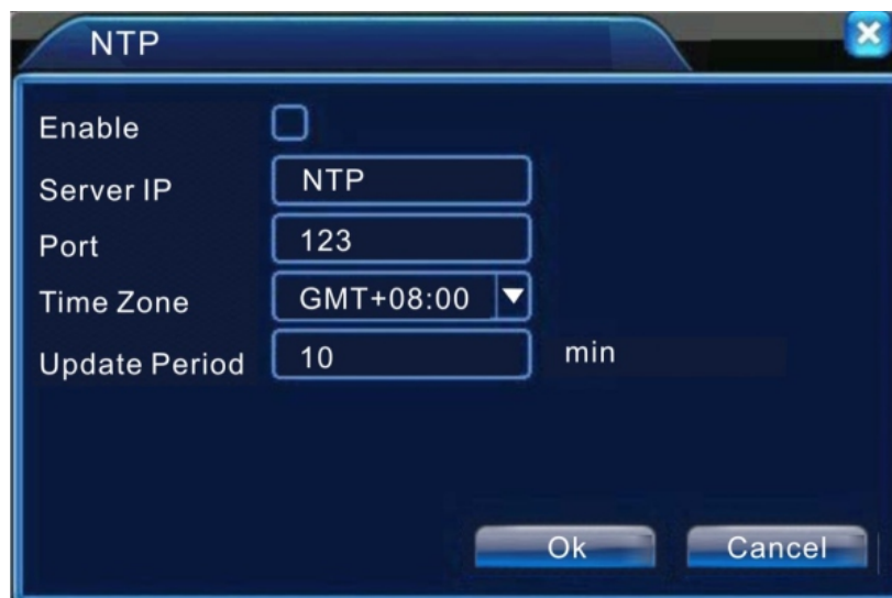
Рис 4.19. Настройка NTP сервера
