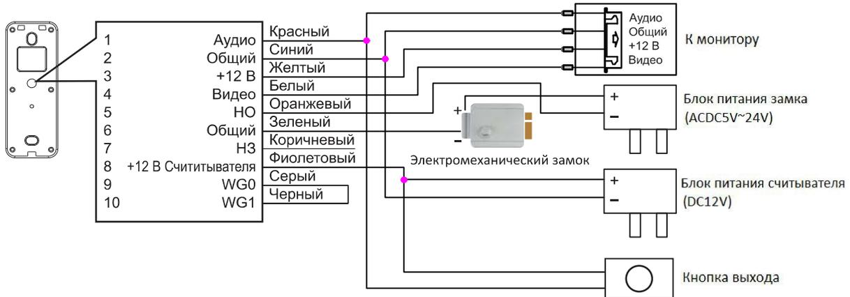
**Примечание:** При подключении к панели замков рекомендуется устанавливать параллельно обмотке замка диод(см. схему) или варистор с напряжением отсечки 20В. Диоды в комплект поставки не входят.
