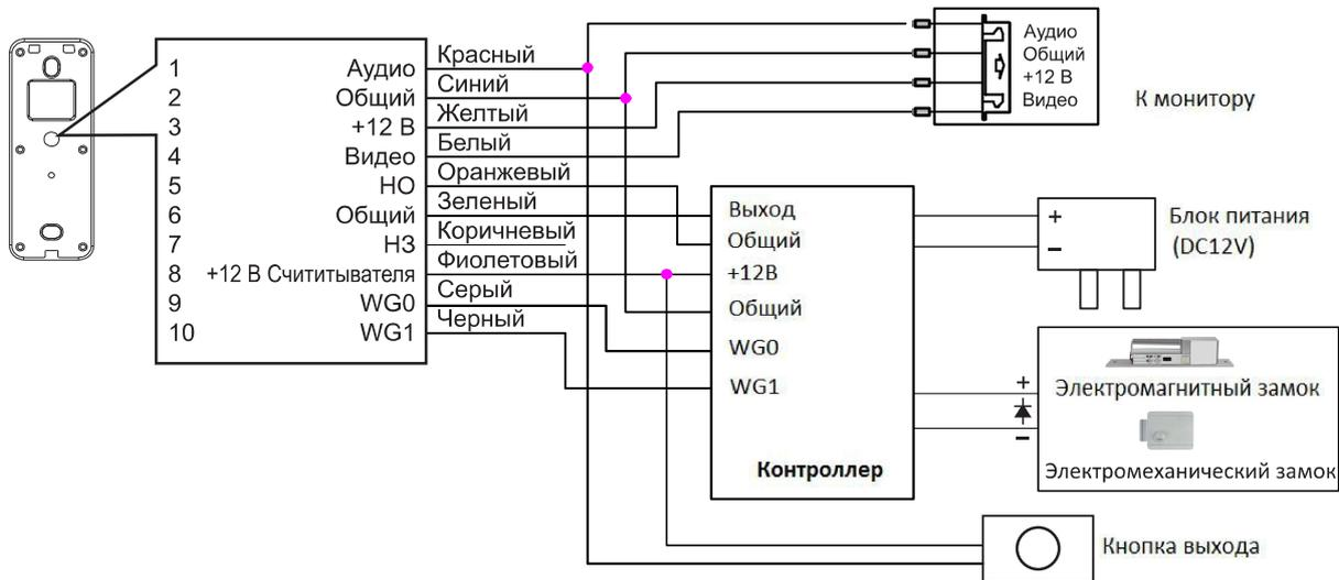
Вызывная панель может работать в режиме считывателя со сторонними контроллерами доступа по интерфейсу Wiegand 26. При работе в режиме считывателя программирование панели не требуется.
