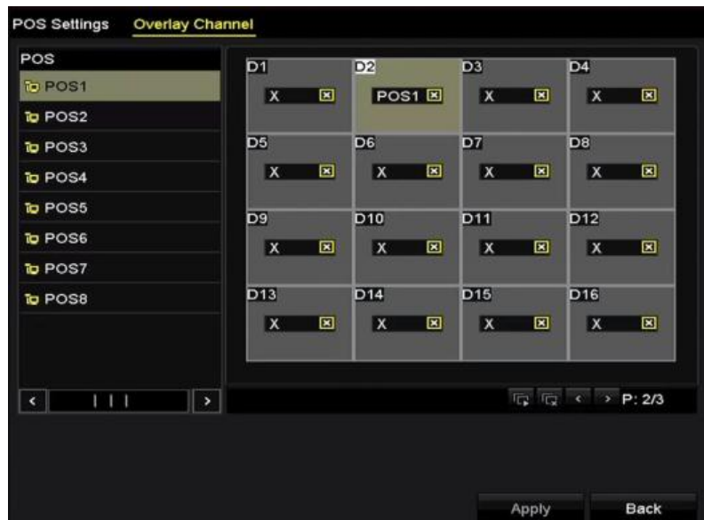
Рисунок 9-15 Настройки наложения канала
