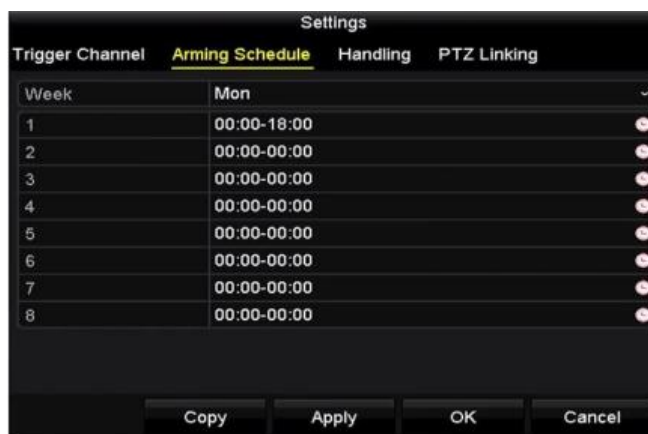
Рисунок 9-17 Установка расписания постановки на охрану
